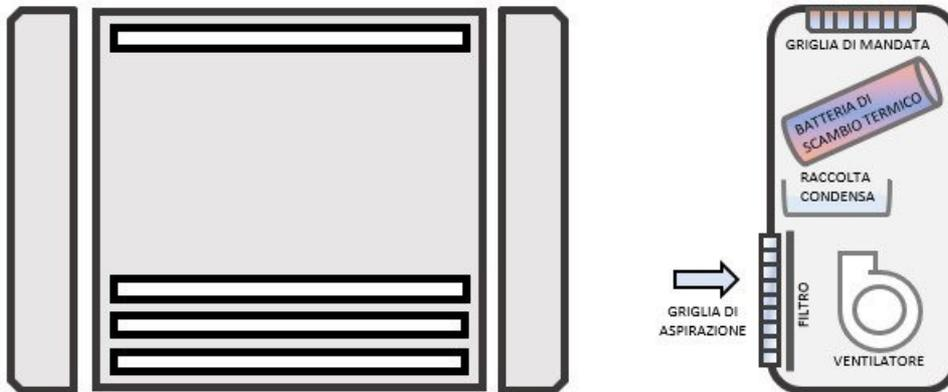
Oltre al classico elemento a parete, esistono anche modelli a soffitto, controsoffitto e pavimento. Lavorano con temperature di mandata più contenute rispetto ai radiatori ( $45 \div 55^\circ\text{C}$ ) e salto di  $5^\circ\text{C}$  tra mandata e ritorno:
