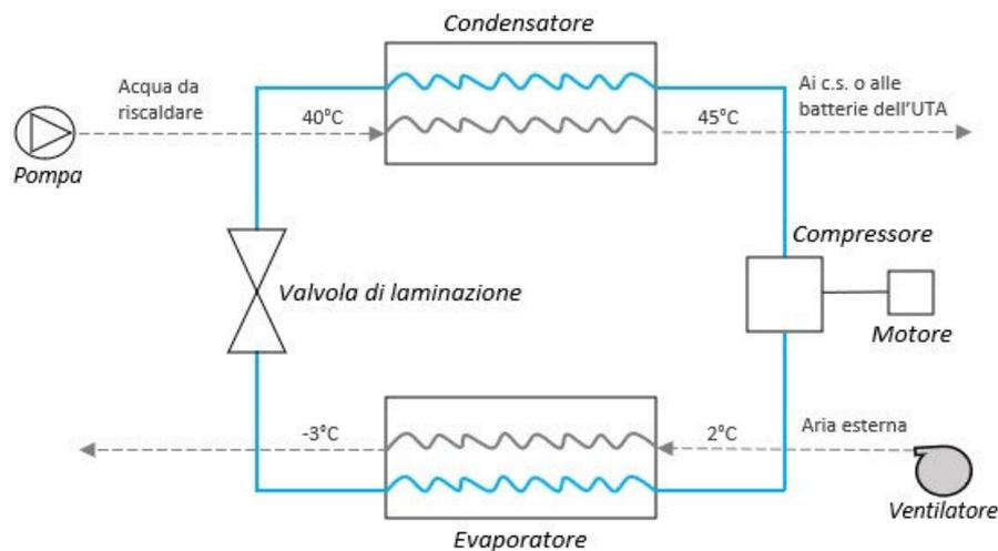
In entrambi i cicli di funzionamento il vantaggio consiste nel non far circolare direttamente negli ambienti il fluido frigorifero e/o nel consentire un trattamento più preciso dell'aria da immettere in ambiente.
