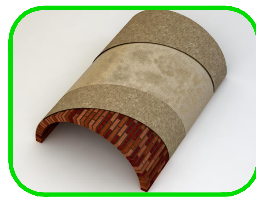
ASSONOMETRIA RINFORZO ESTRADOSSALE DELLA VOLTA A BOTTE
